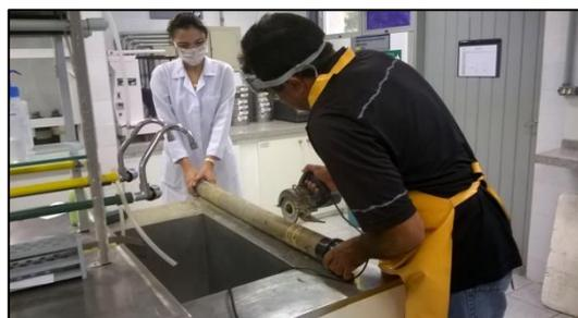
Figura 2 – Abertura do testemunho *liner*.
